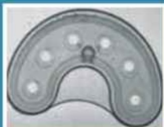
用背光檢測零件尺寸,各部位孔徑清晰可見
